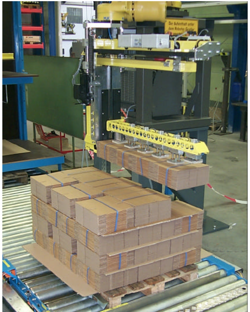
Mit einem Griff setzt der Roboter viele kleine Pakete um. Die Inlinemaschine kann deshalb mit hoher Leistung laufen. 5309/ P0005150
